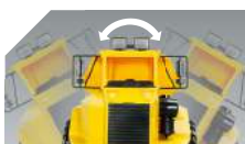
Articulação frontal deslocamento para direita e para esquerda em seu próprio eixo
