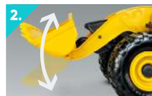
2. Alavanca da Esquerda faz a caçamba bascular.
