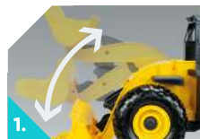
1. Alavanca da Direita faz o braço de elevação levantar e abaixar.
